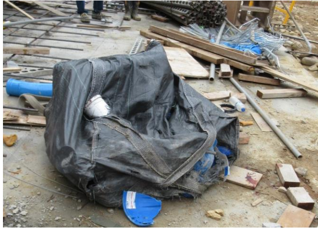
附照3-環眼吊帶穿過太空包吊耳(未發現吊帶或吊耳斷裂)、蘇○承安全帽破裂掉落太空包旁
