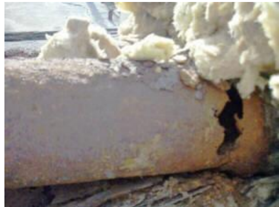
(管線保溫層覆蓋下嚴重腐蝕後洩漏)
