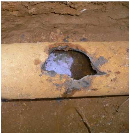
(埋設於土壤或污水槽危害性化學品管線產生腐蝕後洩漏)
