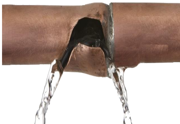
(管線之焊接處因應力集中造成加速腐蝕破裂後洩漏)
