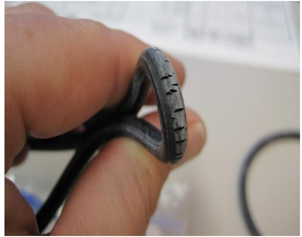
(油封已劣化龜裂)
