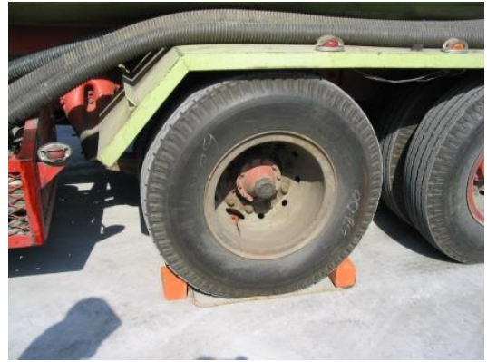
裝設車輪擋固定
