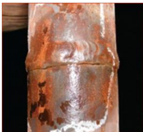
(管線之焊接處因應力集中造成加速腐蝕破裂後洩漏)
