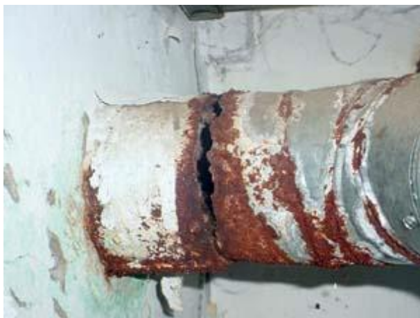
(埋設於土壤或污水槽危害性化學品管線產生腐蝕後洩漏)
