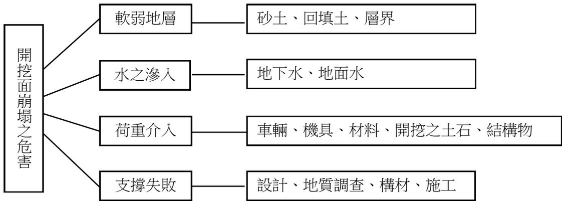
圖3.1 開挖面崩塌之危害狀況引導圖
