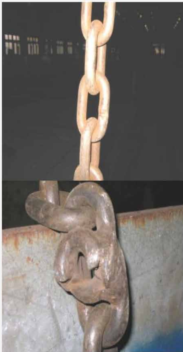
吊鏈不良例—焊補
