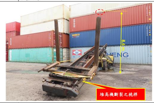
1. 災害現場一堆高機之桅桿為伸長狀態,該桅桿斷裂後倒塌於堆高機之駕駛室,並將駕駛室之頂棚壓毀。
